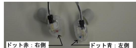
ケーブルの抜き差しによりイヤホン本体のコネクタを破損させた場合は保証対象になりません。ケーブルを交換する際はイヤホン本体やコネクタピンを破損させないように充分に注意して作業してください。
