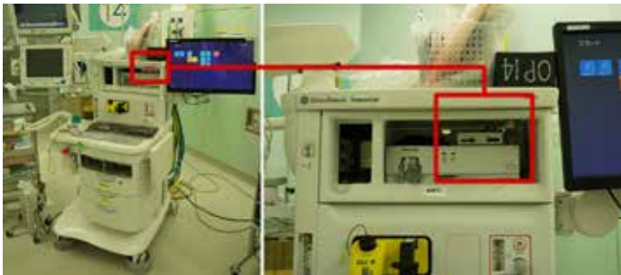
手術室にある麻酔器。 ※手術中も移動できるように車輪が付いている。 ※麻酔器カートのラック内に設置されたインテル® NUC。超小型サイズで麻酔器と一体化している。
