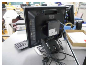
教職員用のモニターの裏側にインテル® NUCを設置することで、机上スペースが大幅に拡大した
