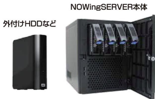
外付けハードディスクはバックアップを定期的に保管する先になりますので、背面のUSBポートに接続することをお勧めします。
