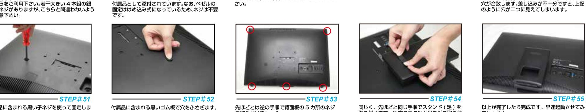
完全に差し込まれると、本体背面左側の穴に設けられた本体側の固定ネジ穴と L 字金具のネジ穴が合致します。差し込みが不十分ですと、上記のように穴が二つ見えてしまします。
