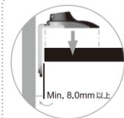
クランプ取り付け時には壁面と天板の間に8mm以上の隙間が必要です。
