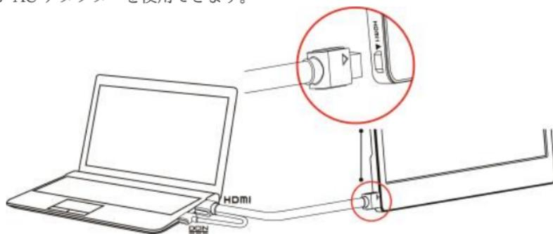
PS.ノート型PCのUSBポート1つで十分な電力を供給できない場合には、モニター画面のちらつきや中断が起こることがあります。その場合は、USB延長ケーブルを使用してACアダプターに接続してください。
